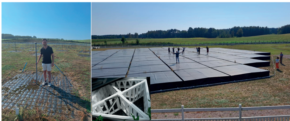
Figure IV: Verschillende LOFAR antennes. Links is een LBA antenne te zien met een mens er naast om de schaal te verduidelijken. In het midden wordt een afbeelding van een HBA antenne getoond, die verborgen ligt onder de tegels getoond in de rechter afbeelding, waar mensen bovenop staan om de schaalgrootte aan te geven. Deze foto's zijn genomen bij station PL612 in Baldy (Polen) door de auteur en zijn collega's.
