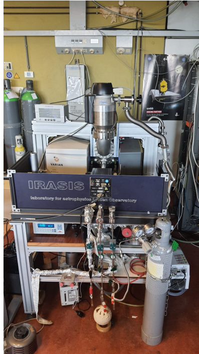
Figure 4: Foto do aparato experimental IRASIS, dedicado a estudar os espectros IV de análogos de gelo astrofísicos.
